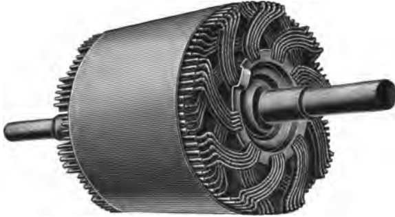
Fortschreitende Wellenwicklung mit Gabelverbindungen der Maschinenfabrik Oerlikon.
